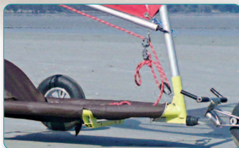
Châssis en 2 parties déboîtables pour le transport dans le coffre de voiture
