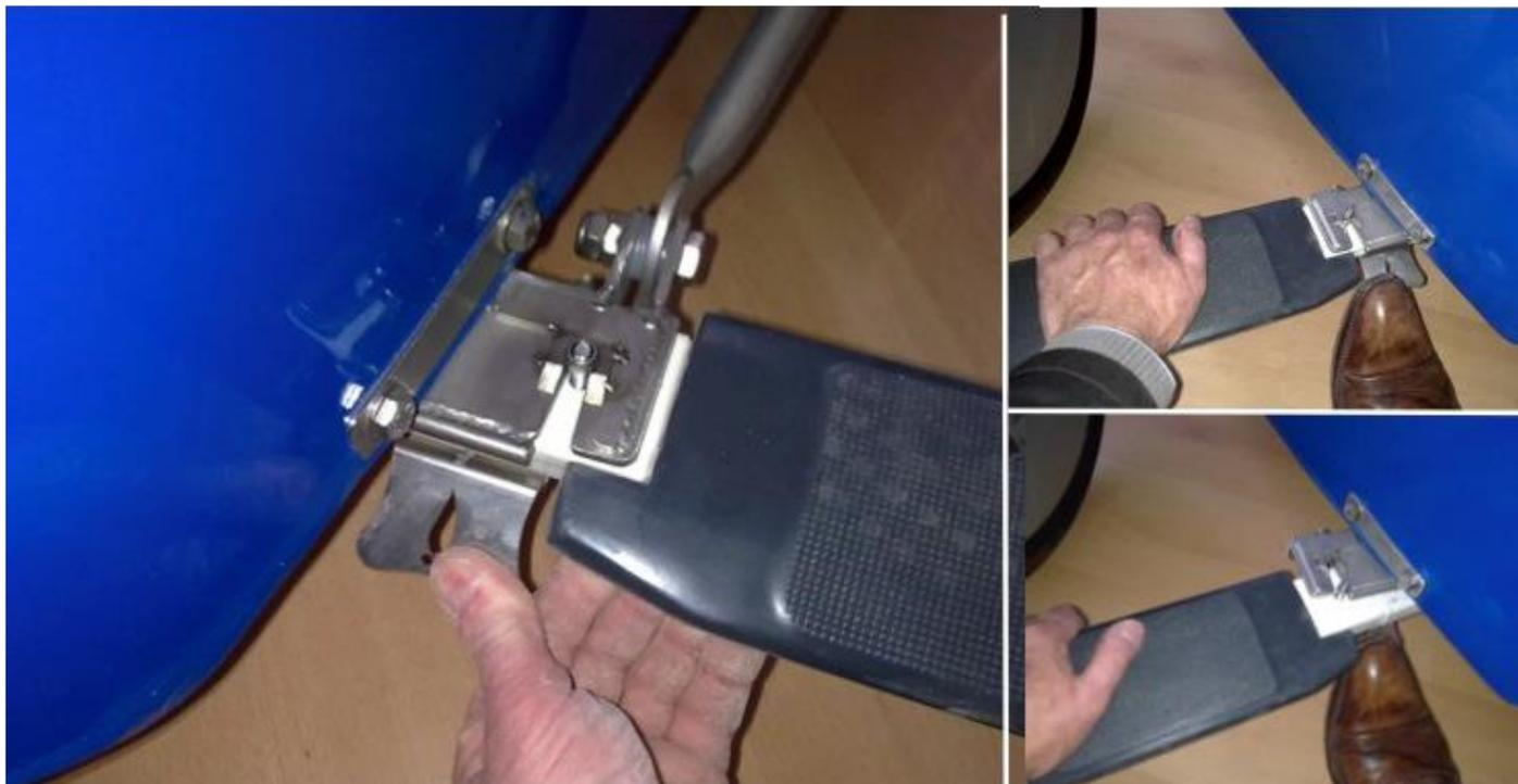
Montez les roues arrière sur les essieux. Et puis serrez l'écrou en utilisant une clé de 22mm. C'est inutile de serrer trop fort. Si la fusée rentre mal dans la roue, utilisez votre index pour aligner les trous.
