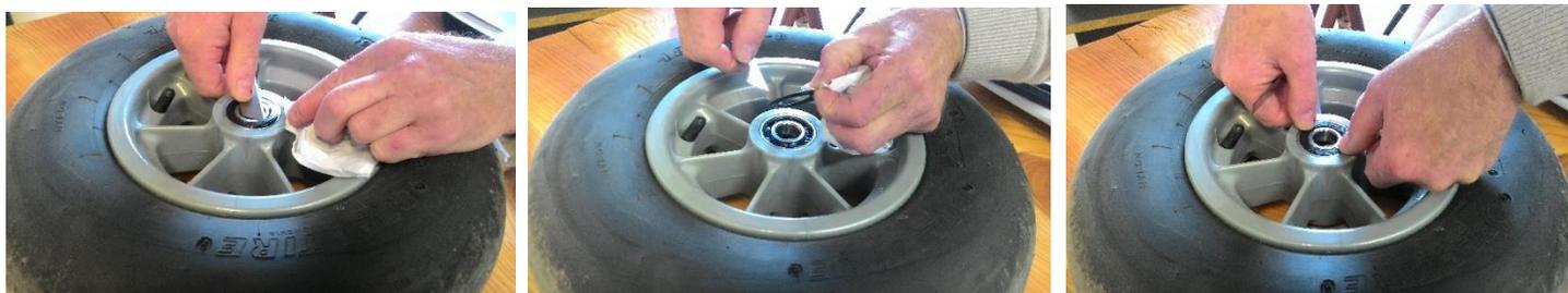
Après le long de stockage, il arrive que le roulement soit bloqué. Si le roulement est bloqué, mettez du dégrippant et débloquez le noyau pour remettre le roulement en rotation. Ensuite, remplissez le de graisse remettez de joint de spi.
