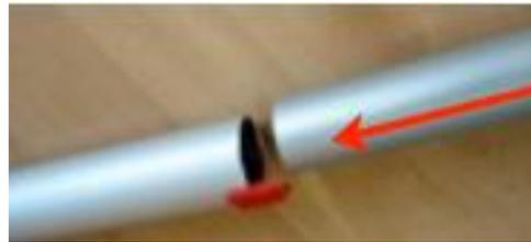
Enfilez le mât dans le fourreau de voile et redressez le tout pour planter le gréement dans le châssis. N'oubliez pas le petit cordage autour du mât.
