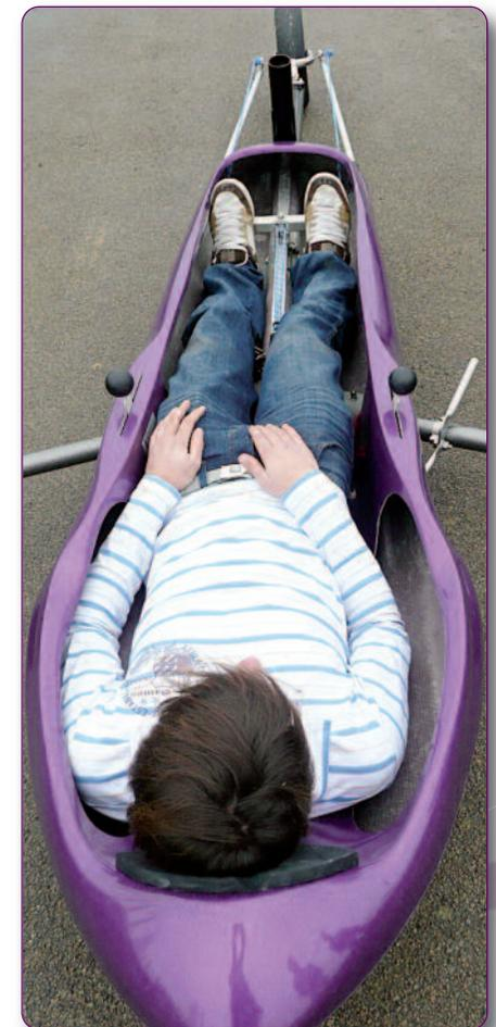
DOUBLE CIRCUIT DE COMMANDE PAR CORDAGE NYLON-KÉVLAR PASSANT PAR LE PALONNIER JUSQU'AU TAQUET DE RÉGLAGE, DOUBLÉ DE VOTRE TRINGLE DE DIRECTION ALU EN PRISE DIRECTE DEPUIS LA POIGNÉE LATÉRALE DE LANCEMENT.
